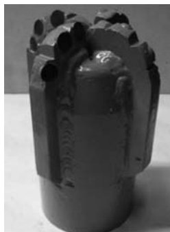
Рис. 15.26. Дегазационное долото \varnothing 121 мм
