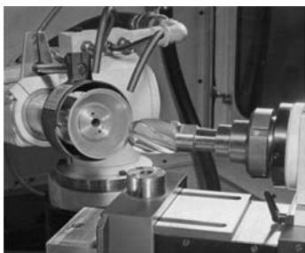
Рис. 9.3. Заточка концевой фрезы по задней поверхности
