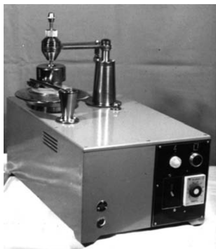
Рис. 11.30. Установка УАС-2М для определения абразивной способности алмазных паст
