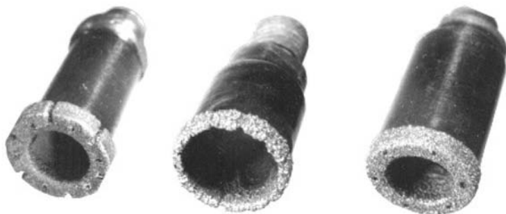
Рис. 10.29. Алмазные сверла-трепаны с алмазосносным слоем, формируемым методом гальваностегии
