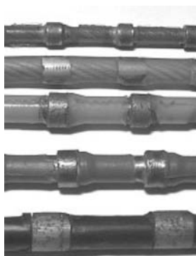
Рис. 15.19. Алмазные канатные пилы для добычи и размерной обработки камня
