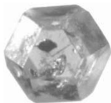
Рис. 2.9. Синтетический алмаз с крупным локальным включением (до нагрева)
