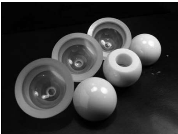
Рис. 12.2. Элементы пары трения «керамическая головка—вкладыш чаши из сапфира»
