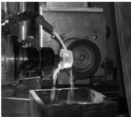
Рис. 12.4. Шлифование внешней конусной поверхности чаши алмазным кругом
