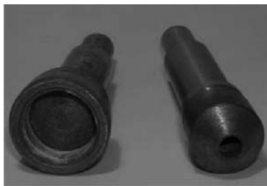
Рис. 12.5. Кольцевой алмазный инструмент для шлифования сферической поверхности вкладыша из сапфира
