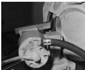
Рис. 9.6. Заточка проходного твердосплавного реза по задней поверхности
