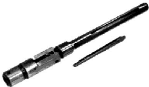
Рис. 10.17. Хонинговальная головка с поликристаллическим бруском
