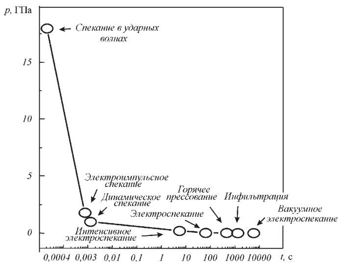
Рис. 15.4. Функциональная связь между приложенным давлением и длительностью процесса спекания
