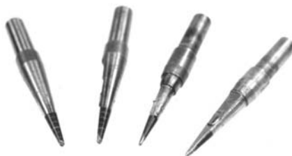
Рис. 10.14. Поликристаллические катоды для АЭОПК каналов в волокнах малых типоразмеров
