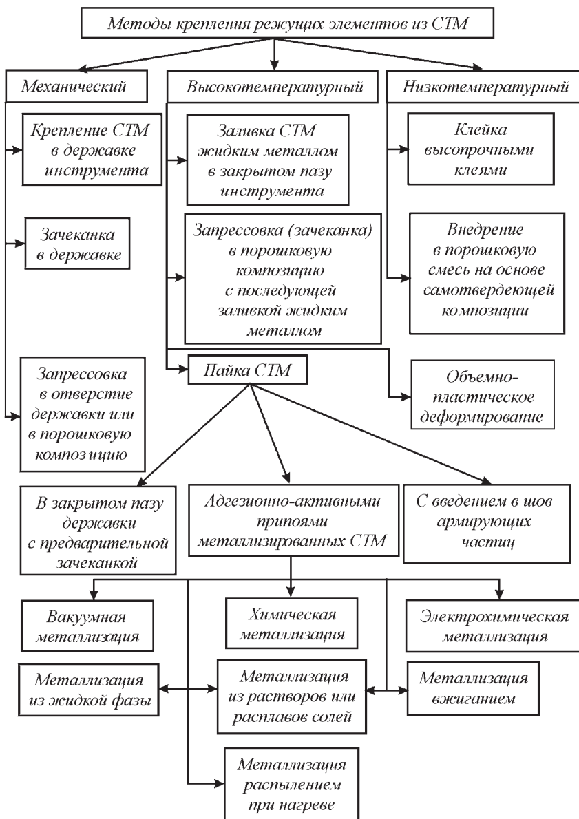
Рис. 6.1. Методы крепления режущих элементов из СТМ
