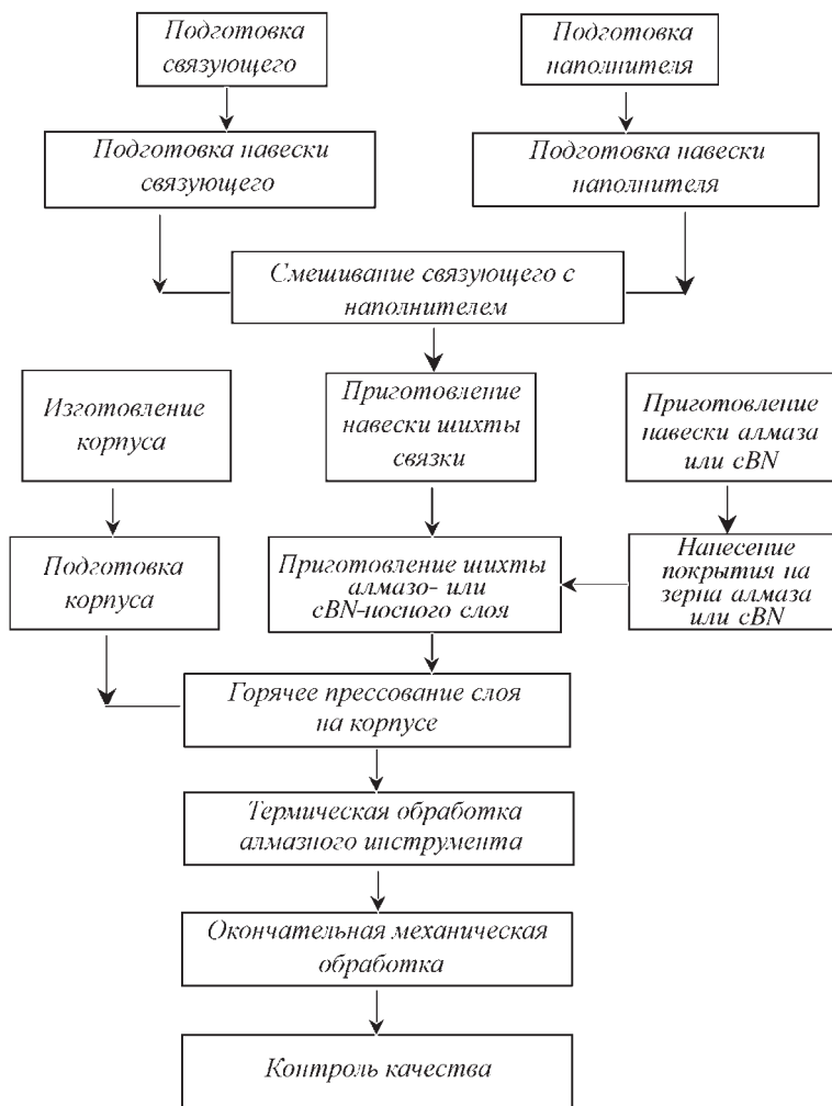
Рис. 7.9. Технологическая схема изготовления кругов на органической связке
