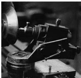
Рис. 9.1. Обработка радиуса при вершине расточного реза
