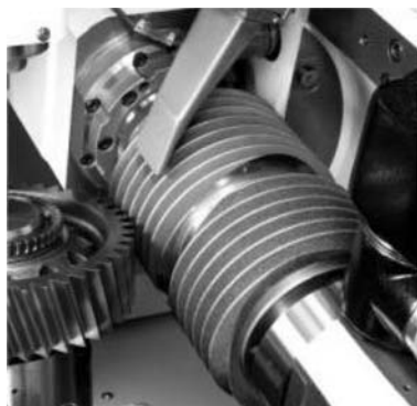
Рис. 11.23. Обработка зубчатого колеса инструментом фирмы Карр
